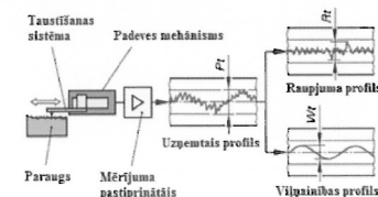
3.3.att. Kontakta profilogrāfa-profilometra darba principiālā shēma
