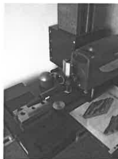
2.1. att. Taylor Hobson Form Talysurf Intra 50 mēraparāts
