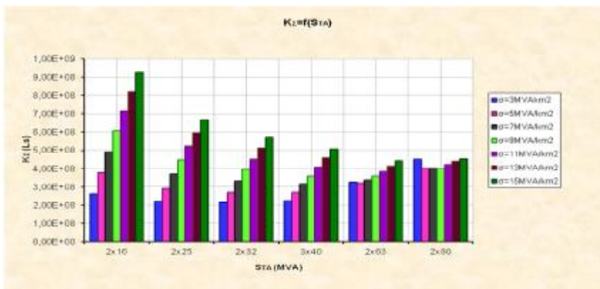
5.1. att. Elektroapgādes sistēmas summārie kapitālieguldījumi atkarībā no apakšstacijas transformatoru S_{TA} jaudas K_{\Sigma}=f(S_{TA}) histogrammas veidā
