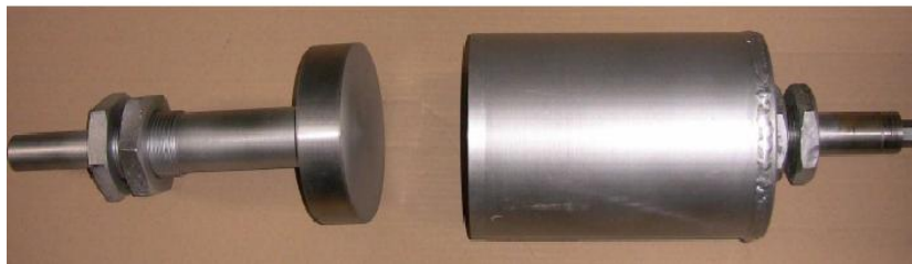
2.4. att. Betona presforma, pielāgota Instron 8802 mašīnai
