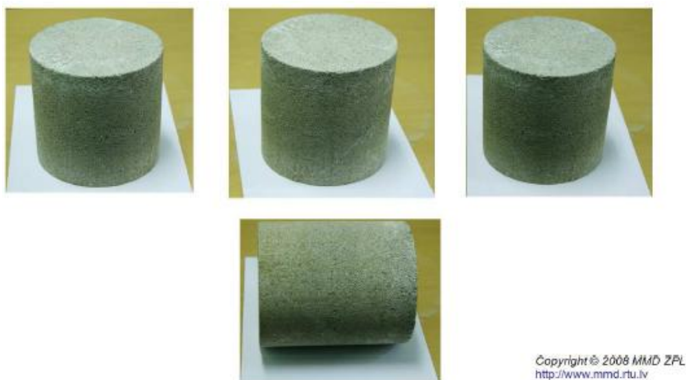
2.6. att. Testēšanas mašīnā Instron 8802 uzformētie betona cilindru paraugi
