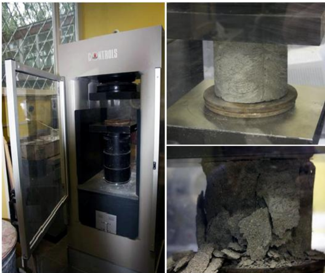
2.11. att. Paraugu sagraušanas iekārta (pa kreisi) un parauga izskats pirms (pa labi augšā) un pēc (pa labi apakšā) sagraušanas eksperimenta
