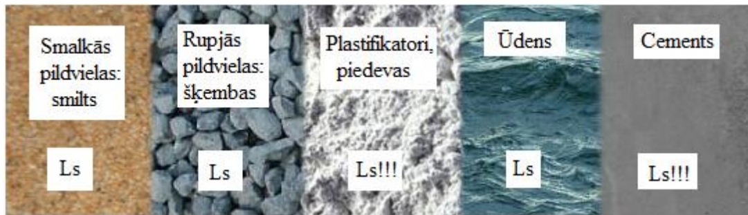
4.3. att. Betona maisījuma sastāva izejvielas
