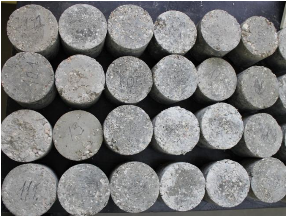
2.10. Testēšanas mašīnā Zwick uzformētie betona cilindru paraugi
