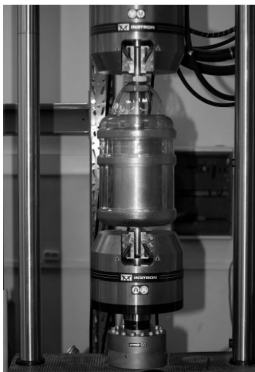
2.5. att. Testēšanas iekārtas Instron 8802 hidrožokļos iestiprinātais testēšanas cilindrs (presforma)
