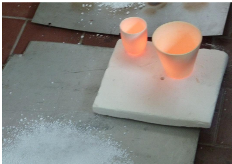
7. att. \alpha -Trikalcijs fosfāta sintēze, atdziestais trikalcijs fosfāts un neatdzisuši tīģeļi
