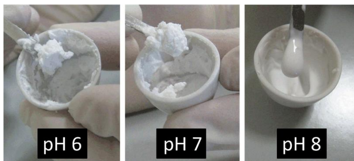
42. att. Cementa pasta 1 min pēc maisīšanas sākuma, P/\bar{S} = 1,75 , fosfāta jonu koncentrācija 0,5 M, bez šķidrās fāzes piedevām
