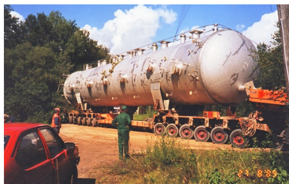
2.8.att. Īpaši smagas satiksmes slodzes piemērs, 140 t smaga konstrukcija
