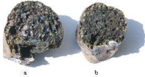
6.att. Ar divstadiju paņēmieni iegūtas Apriķu (a) un Nīcgales (b) keramzīta granulas.
