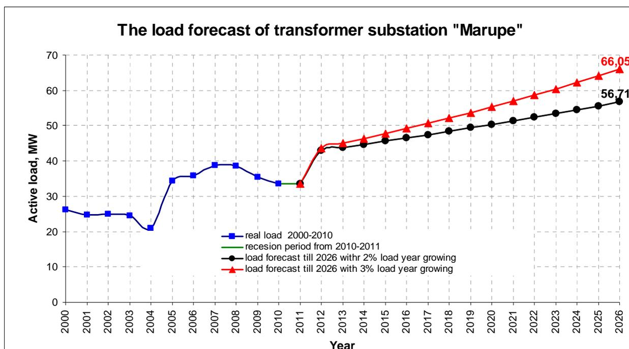
Fig. 2.3. The load forecast of 110/20-10 kV TS „Marupe” from 2000 till 2026
