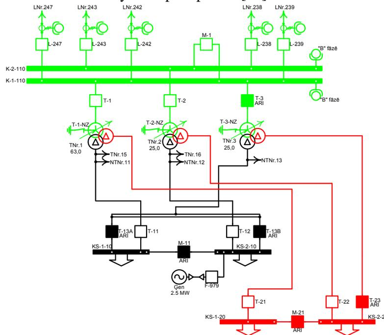
Fig. 2.1. The principal scheme of 110/20-10 kV TS „Marupe”
