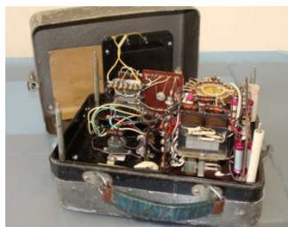
1.10. att. II-tipa kombinētais mērīšanas līdzeklis II4380 un tā iekšējā uzbūve
