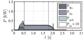
(d) Power losses in robot controller,  $1/2\dot{q}_{i,max}$ ,  $1/2\ddot{q}_{i,max}$
