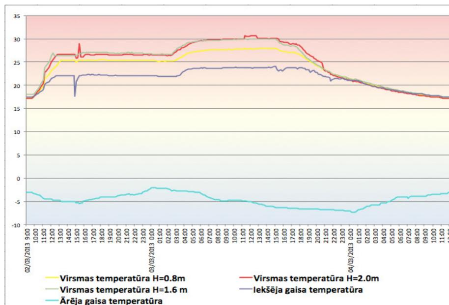
Fig. 2.6: Virsmas temperatūru dati eksperimentālā objektā
