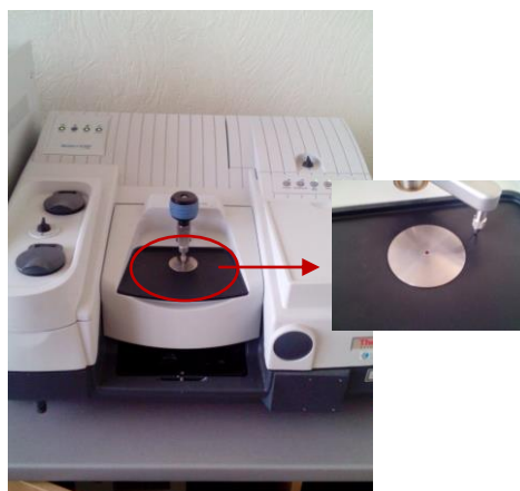
2.4.5.1. att. Furjē transformāciju infrasarkanā spektrometrs Thermo Fisher Scientific, Nicolet 6700
