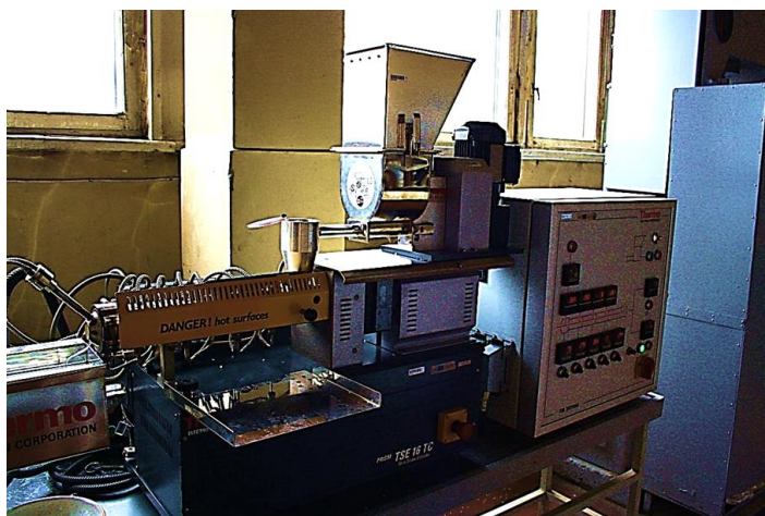
2.2.1. att. Divgliemežu ekstrūderis – PRISM TSE 16 TC
