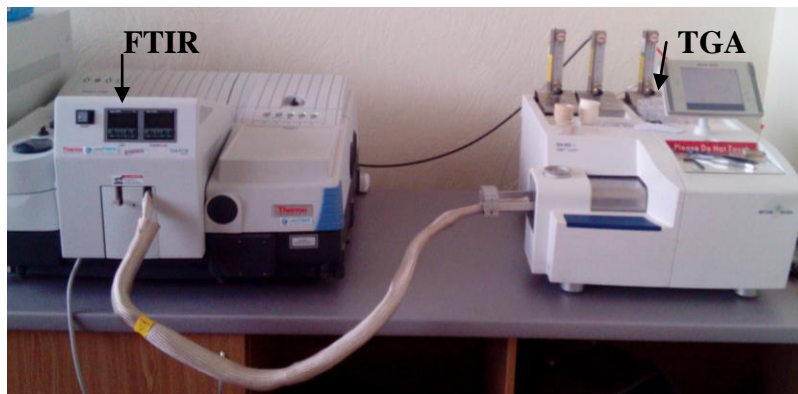
2.4.12.1. att. TGA iekārta Mettler Toledo TGA1/SF ar Furjē transformāciju infrasarkanā spektrometru Thermo Fisher Scientific, Nicolet 6700
