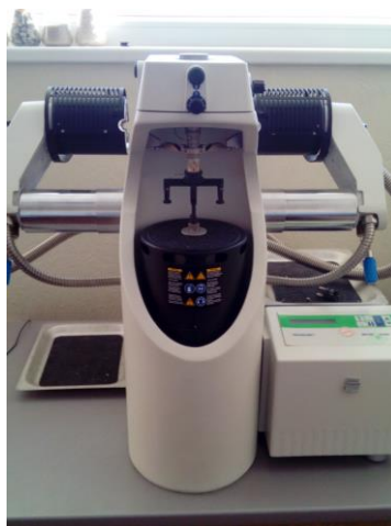
2.4.4.1. att. Dinamiski mehāniskās termiskās analīzes iekārta Mettler Toledo DMA/SDTA861 e
