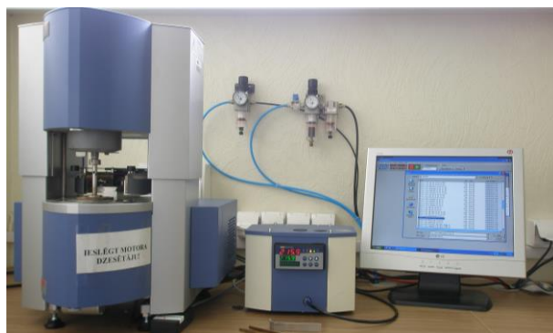
2.4.10.2. att. REOLOGICA StressTech NOVA rotācijas viskozimetrs
