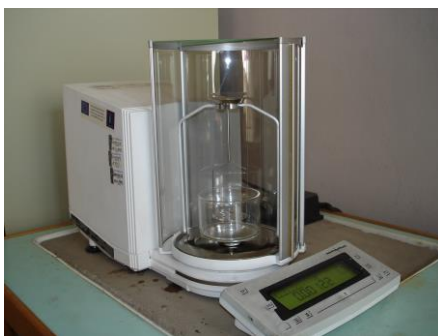
2.4.3.1. att. Sartorius KB BA 100 elektroniskie svāri ar hidrostatiskās svēršanas aprīkojumu
