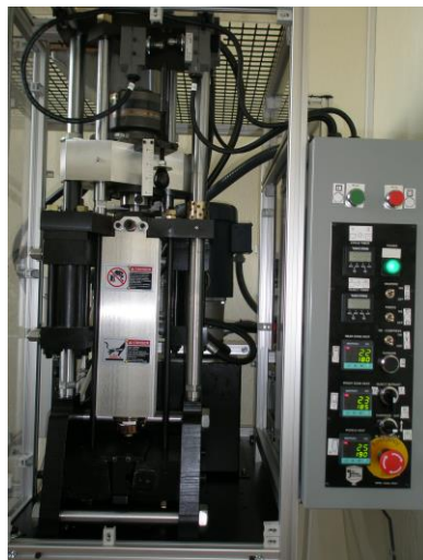
2.3.1. att. Vertikālā laboratorijas liešanas mašīna Minijector 55
