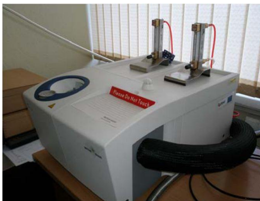
2.4.2.1. att. Mettler Toledo DSC1/200W diferenciālais skenējošais kalorimetrs
