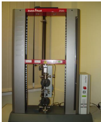
2.4.6.1. att. Universālā materiālu pārbaužu iekārta Zwick Roell
