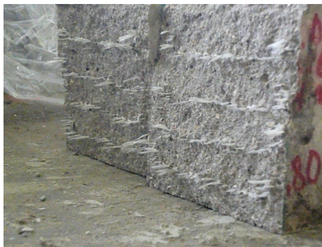
9. att. Betona B50 prizmas (ar 4 armējošiem sietiem) virsma pēc pilnīgas parauga pārlaušanas.
