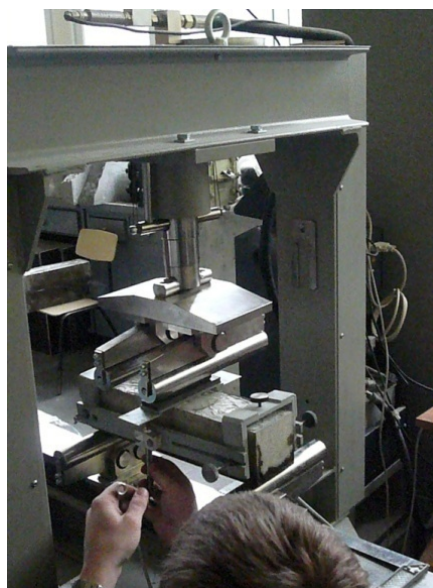
5. att. Prizmu testēšana uz četru punktu lieci.
