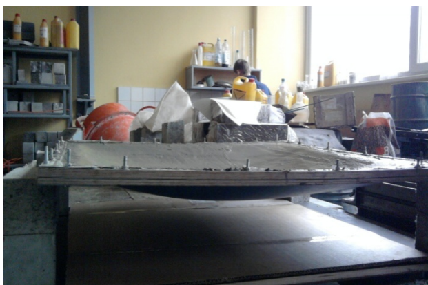
4. att. Izliktas čaulas formas veidošana ar pašsvaru.
