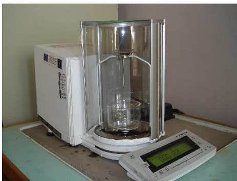
2.22. att. Sartorius KB BA 100 elektroniskie svāri ar hidrostatiskās svēršanas aprīkojumu YDK 01 .
