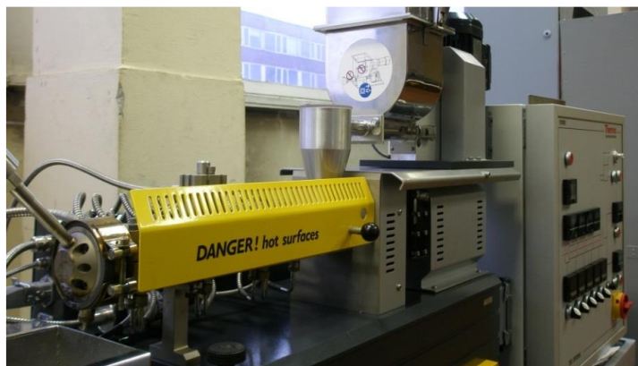
2.3. att. Ekstrūderis PRISM TSE 16 TC .
