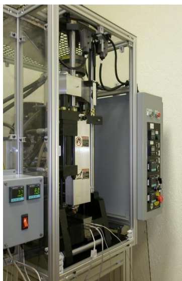
2.9. att. Vertikālā spiedliešanas mašīna Minijector 55 .
