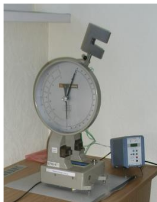
2.16. att. Instrumentētā trieciena izturības noteikšanas iekārta Zwick 24.
