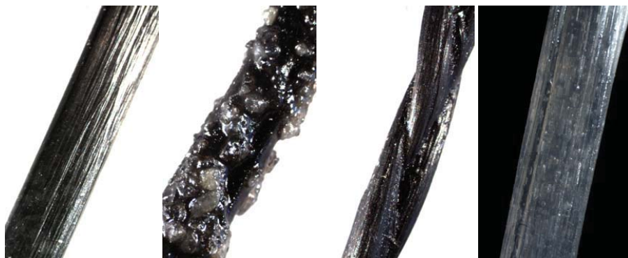
2.20. att. Kompozītās oglekļa un stikla šķiedras ar gludu, raupju virsmu un viļņotu formu: CF1, CF2, CF3 un GF2 (no kreisās puses).
