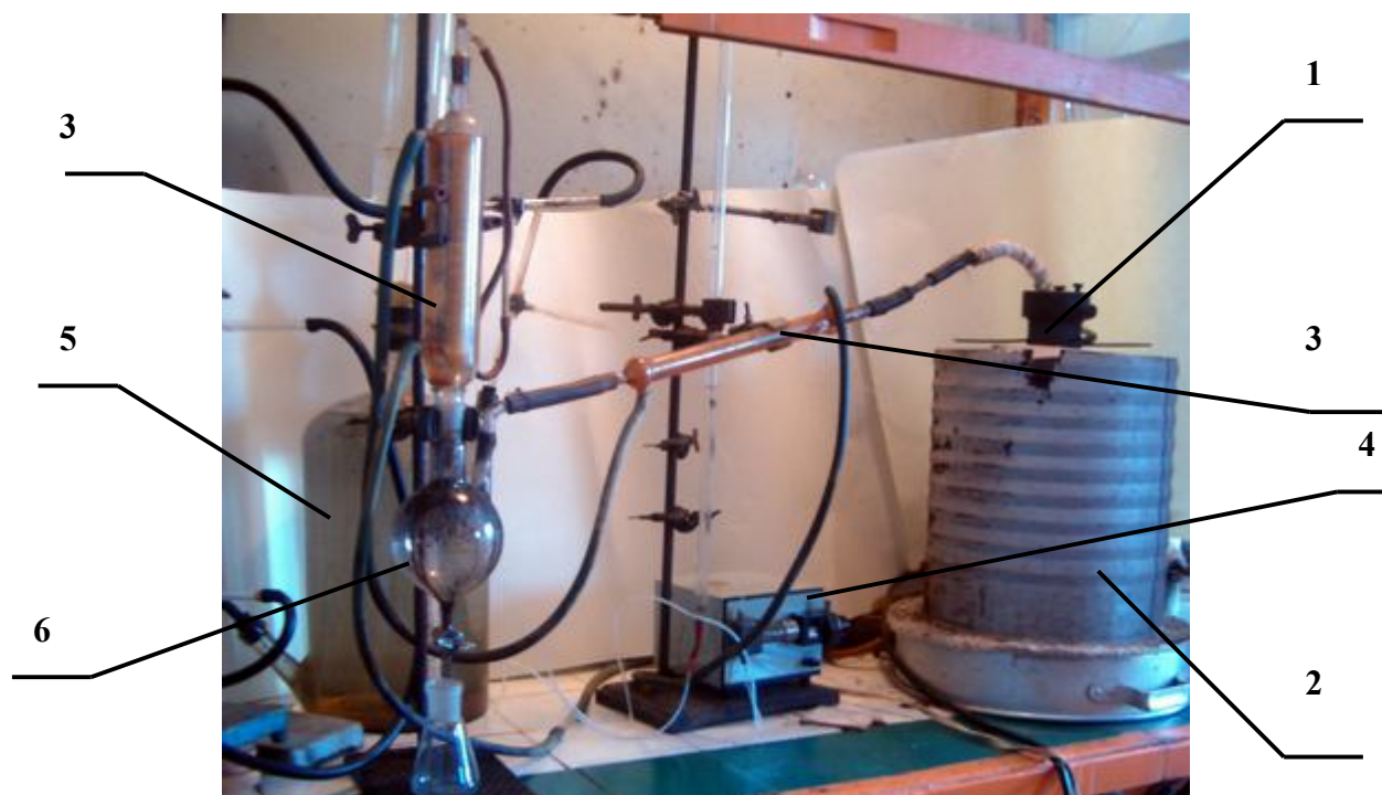
2.3. att. Aktivācijas procesa aparātūra: 1 – aktivācijas retorte; 2 – mufeļa kamera ar elektrisko apsildi; 3 – dzesētāji; 4 – pārkarsējamā ūdens dozatorsūknis; 5 – gāzu uztveršanas un mērīšanas balons; 6 – aktivācijā noreagējušā kondensējušā ūdens uztveršana.
