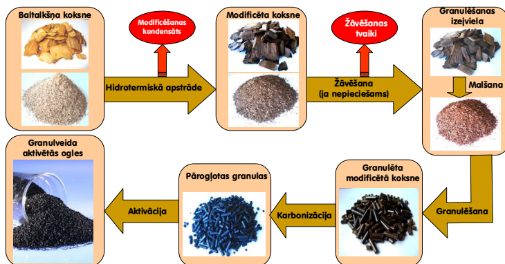
1. att. Eksperimentālā shēma granulveida aktivēto ogļu iegūšanai no modificētas baltalkšņa koksnes
