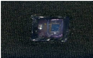
3.att. Tekstildrānā integrēts optiskais sensors.
