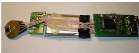
1. att. Izstrādātajā prototipā integrētā mazgabarīta bezvadu PPG maketierīce
