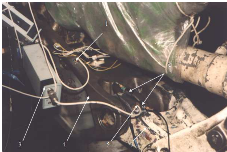
4. att. Aparatūras elementu izvietojums: 1, 5 – AE pārveidotāji; 2 – US pārveidotāji; 3 – priekšpastiprinātājs; 4 – amortizatora galviņa
