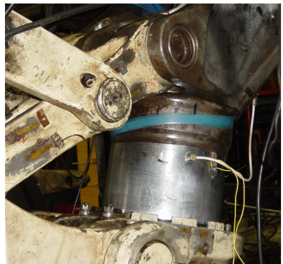
10. att. AE pārveidotāja un tenzodevēja izvietojums
