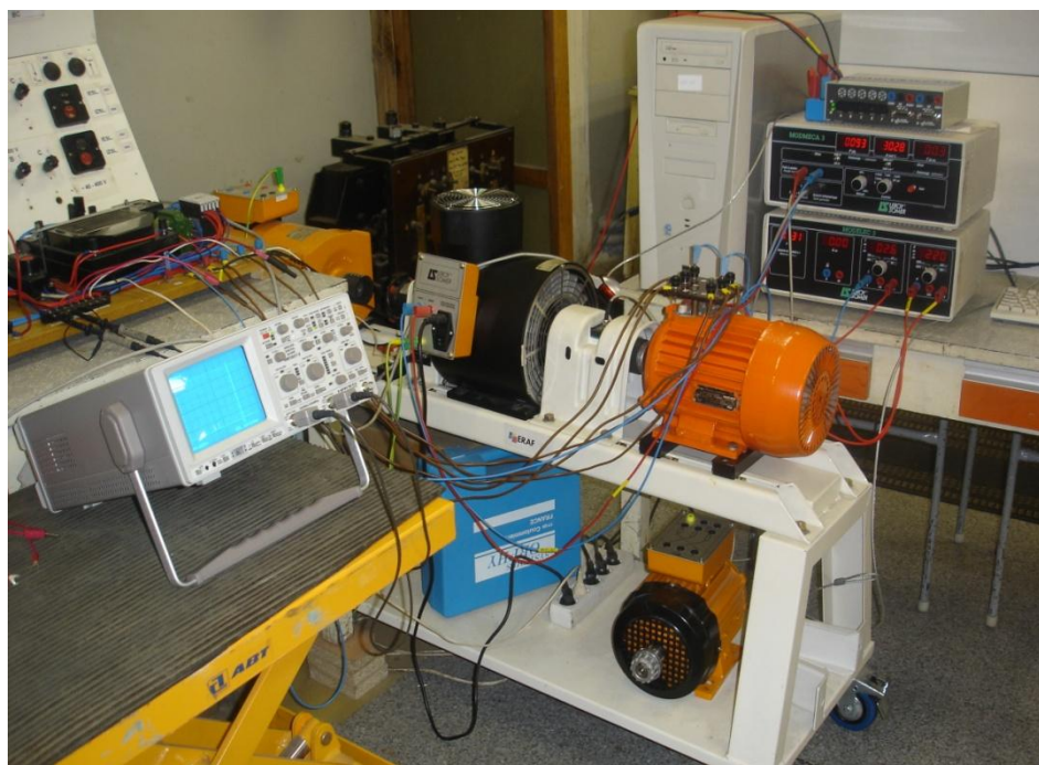
4.2. att. Stends asinhronā dzinēja parametru noteikšanai
