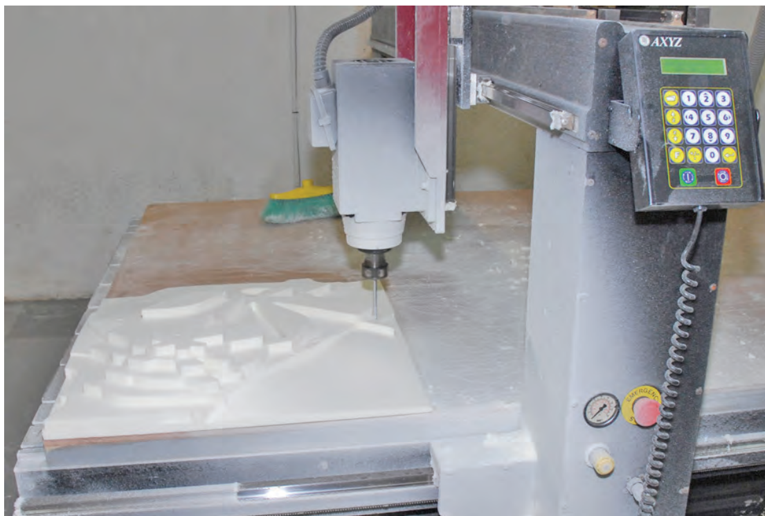
3.29. att. Frēzēšana ar Axyz Corporation 3-asu ciparvadības iekārtu. [A.R.]
