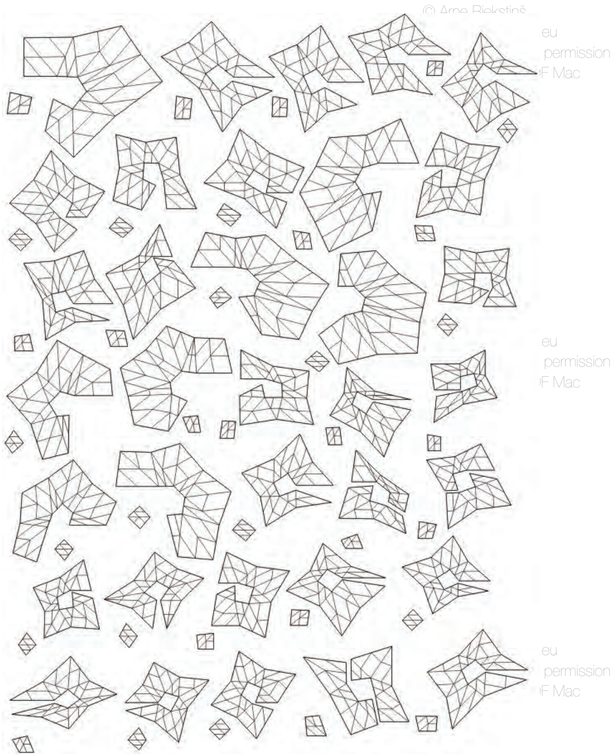
3.14. att. Attēlā parādītas 17 šūnām nepieciešamo frēzējamo detaļu izklājums. [A.R.]
