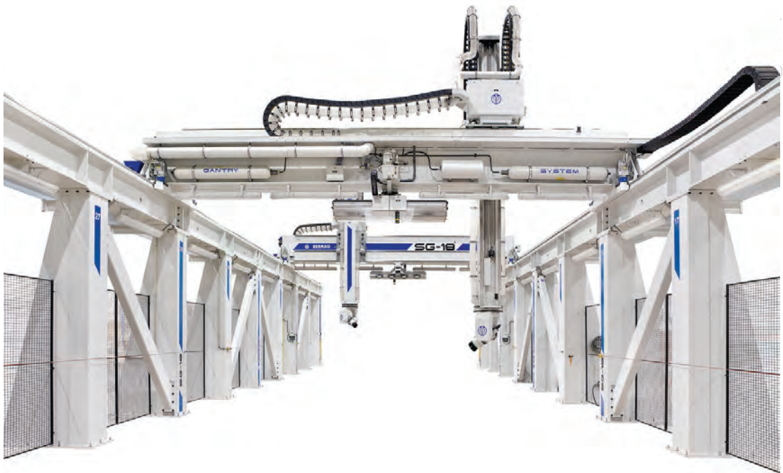
1.38. att. Viena no lielākajām 5-asu CNC iekārtām – Bermaq SG-XXL ar divām frēzēšanas galvām, kuras darba dimensijas var būt no 18000x4000x1000 mm līdz 60000x8000x3000 mm. Ar šādu frēzēšanas iekārtu var izgatavot vienā piegājienā veselu vēja ģeneratora spārnu, luksusa jahtas korpusu vai arī ēkas detaļu mērogā 1:1.
