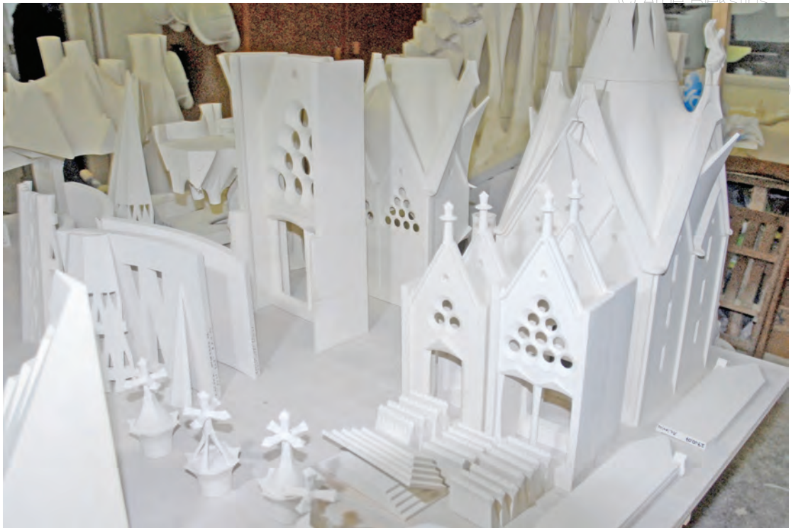
2.5. att. Dažādu detaļu variantu ģipša maketi, veidoti ar trīsdimensiju printeri. [A.R.]
