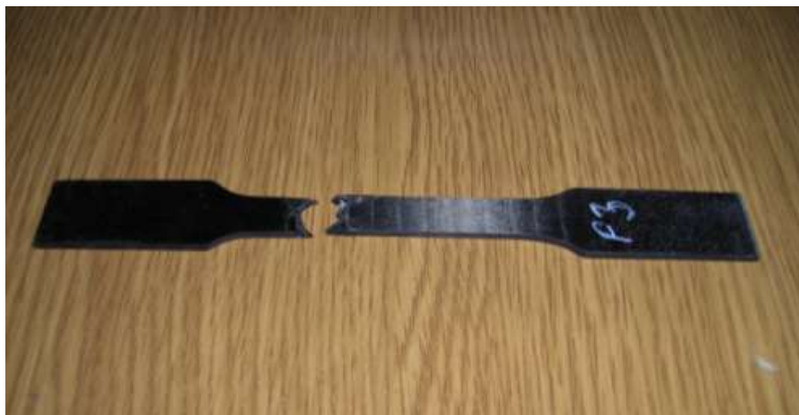
4.11.att. Pārbaudīts sarežģīti armēts ogleņķiedras paraugs
