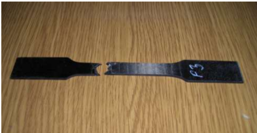
3.10.att. Pārbaudīts sarežģīti armēts ogleņšķiedras paraugs
