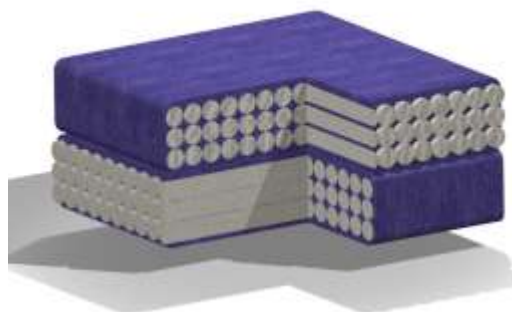
2.2.att. Divos virzienos orientētas šķiedras vai daudzslāņu kompozītmateriāli
