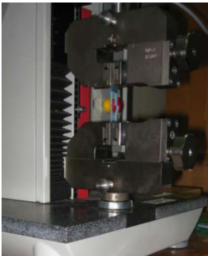
3.1.att. Testēšanas iekārta ar nostiprinātu mikroparaugu
