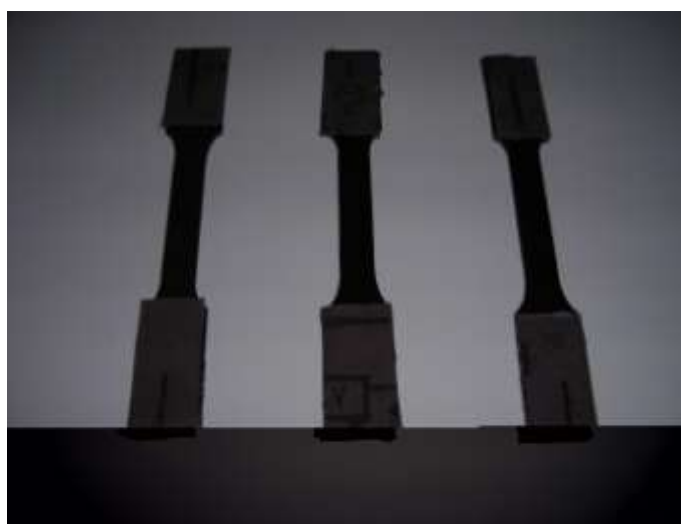
3.14.att. Dinamiskiem testiem sagatavoti paraugi
