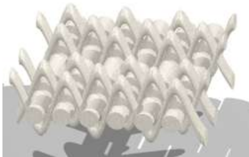
2.3.att. Trīsdimensionāli orientētas šķiedras vai telpiski cauršūti kompozītmateriāli
