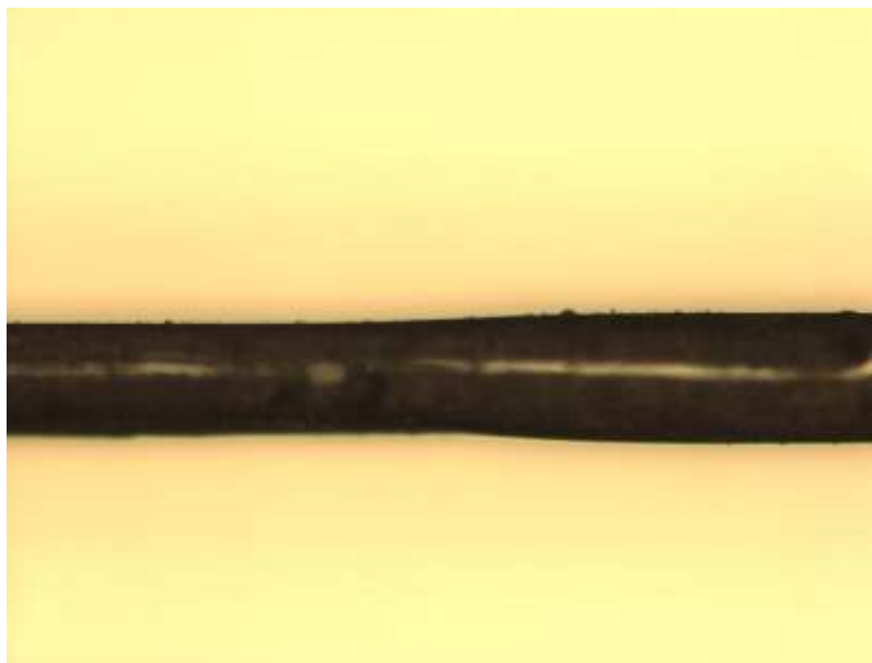
3.3.att. Ogļšķiedras diega mikroparaugs palielinājumā
