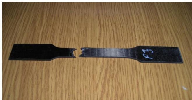
5.att. Pārbaudīts sarežģīti armēts ogļšķiedras paraugs
