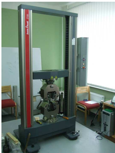
4. att. Laboratorijas izmēģinājumi RTU laboratorijā. Materiāla stiepšana (mašīna „Zwick z150”)
