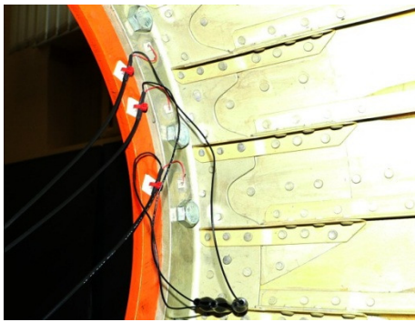
31. att. Trīs pjezoelektriskie sensori pielīmēti uz ribas #17 virsmas bultskrūves savienojumu pievilkšanas spēka zuduma monitoringam
