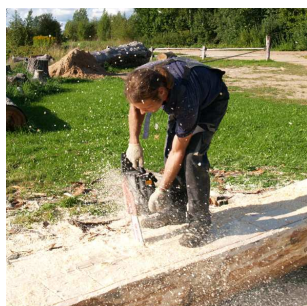
16.att. Iezāģēšana šķērsām šķiedrai laivas iekšpusē
