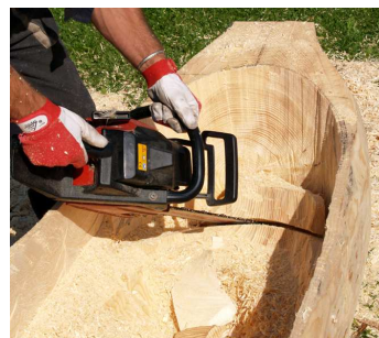
26.att. Laivas gala iekšpuses pēdējās liekās masas izņemšana ar motorzāģi
