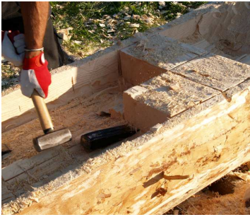
20.att. Liekās masas izņemšana no laivas iekšpuses ar ķīļiem
