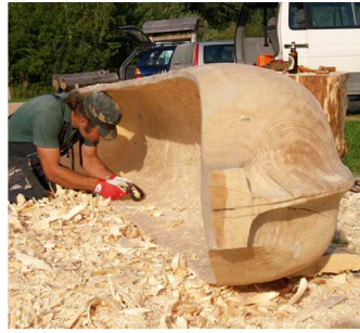
29.att. Bortu vienmērīga biezuma piestrāde ar pusapaļo slīimestu
