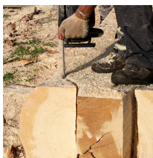
14.att. Formas piezāģēšana laivas priekšgalam
