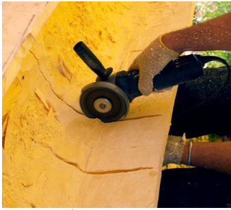
28.att. Iezāģēšana ar leņķa slīpmašīnu borta vienmērīga biezuma piestrādei
