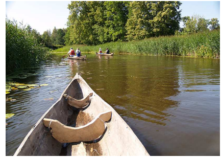
3.att. Bortu nostiprinošie elementi izvēršai laivai
