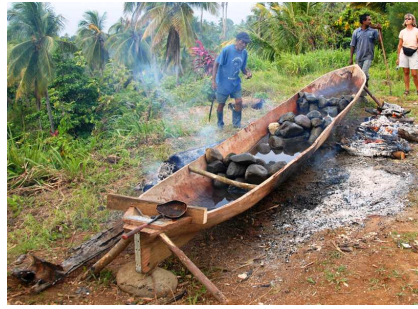
2.att. Laivas sautēšana no iekšpuses
