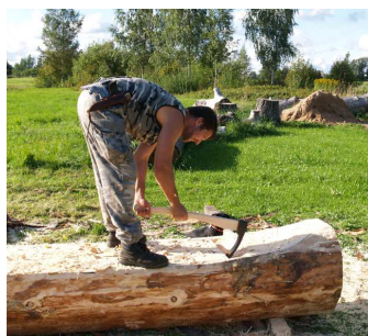
18.att. Liekās masas izciršana no laivas iekšpuses
