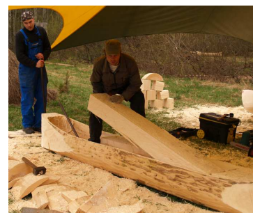
19.att. Lielo atgriezumus izcelšana no laivas iekšpuses
