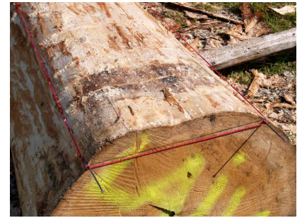
7.att. Laivas apakšas atzīmēšana
