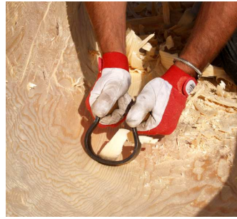
30.att. Laivas iekšpusē apstrāde ar pusapaļo slīimestu
