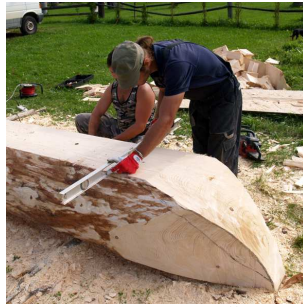
21.att. Laivas sagatavošana un nolīmeņošana precīzai apstrādei
