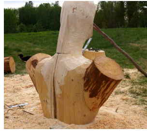
19.att. Savienojuma pārbaude piecām savstarpēji saistītām detaļām
