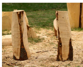
14.att. Sagataves ar pilnīgi atzāģētu rupjo masu
