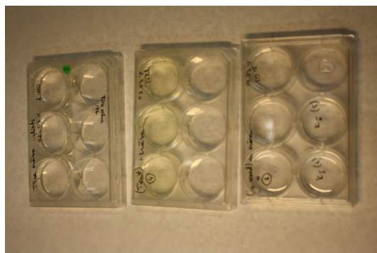
2.9. att. Testa plates D.magna kustību inhibēšanas pārbaudei ar koka konservantiem apstrādātu koka paraugu ekstrakta klātbūtnē
