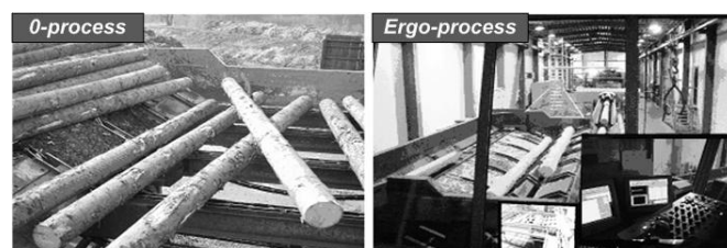
2. att. Darba apstākļu salīdzinājums pirms ( 0-process ) un pēc automātiskās (datorizētās) šķirošanas līnijas ieviešanas ( Ergo-process ).
