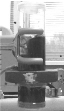
3.5.1. att. Maisīšana ar impulsa elektromagnētisko lauku (dzelz pulveris ūdens šķīdumā)
