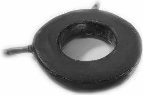
3.4.3. att. Cilindriska spole: (Coil(01)) ar Cu vadu.
