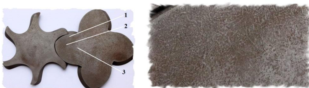
3.1. att. Ar Heines reaktīvu apstrādāto rotoru makropieslīpņi
