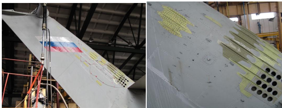
5.2 att. Lokālo Zonu plaisāšanas piemēri uz ķīļa sijas a) ķīļa sijas kopskats, b) ķīļa sija kā viena Lokāla Zona.
