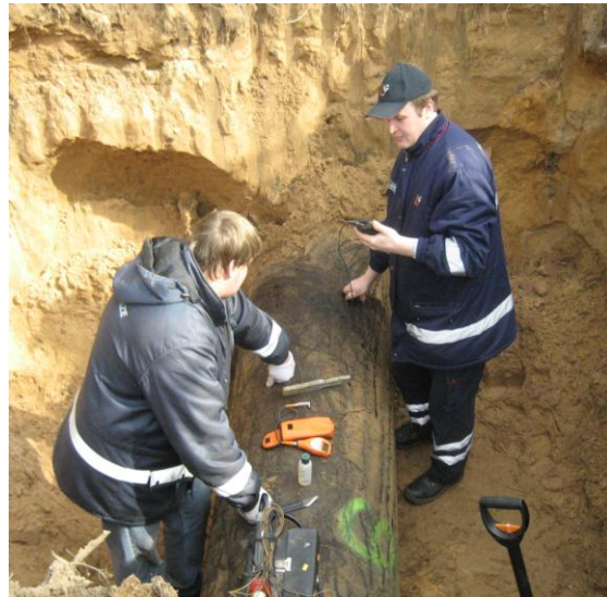
1.5. att. Metāla caurules sienas biezuma mērīšana skatrakumā
