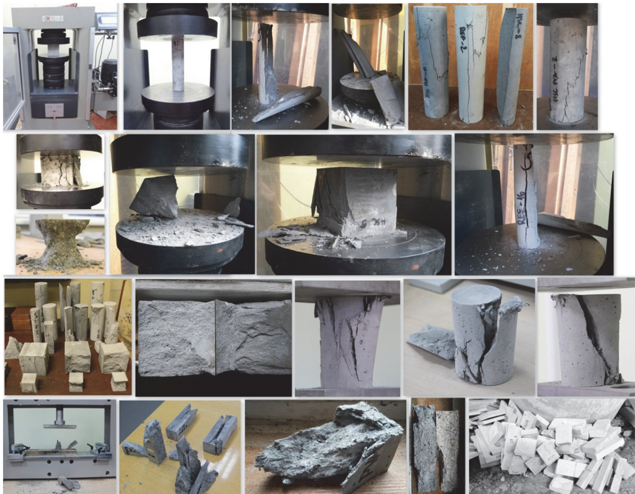
3.10. att. Dažādu paraugu sagraušana spiedē (RTU laboratorija)
