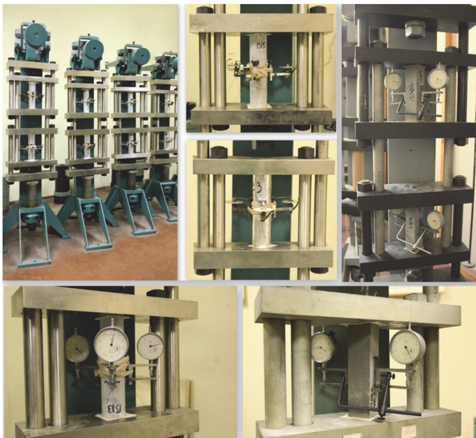
3.11. att. Šļūdes vienasīgo deformāciju noteikšana spiedē (RTU laboratorija)
