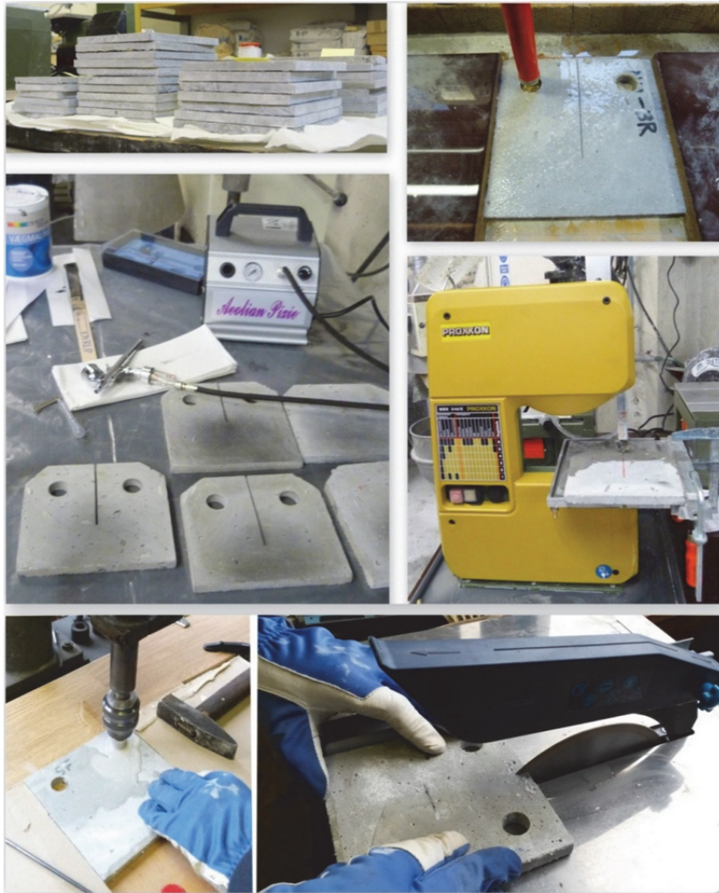
3.8. att. Koncentrētas stiepes (CT) paraugu gatavošana ilglaicīgajām un stiepes plaisu izpētes pārbaudēm (DTU, RTU laboratorija)
