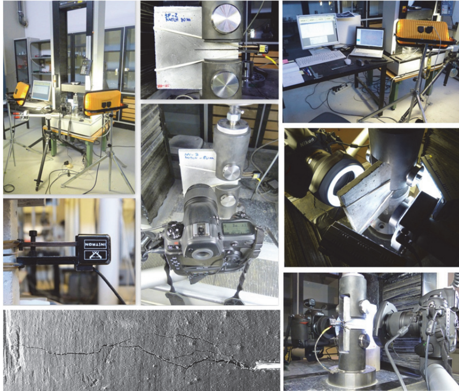
3.15. att. Plaisu rašanās un tālākas attīstības noteikšana ar bezkontakta digitālo attēlu pārvietojumu noteikšanas un analīzes sistēmu GOM „Aramis” (DTU laboratorija)
