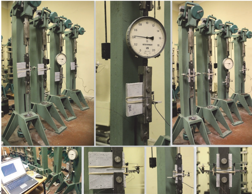
3.17. att. Šļūdes vienasīgo deformāciju noteikšana stiepē (RTU laboratorija)
