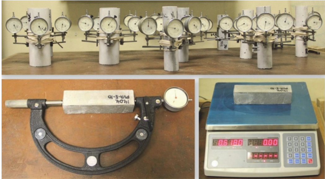
3.12. att. Žūšanas rukuma vienasīgo deformāciju noteikšana pēc divām metodikām (RTU laboratorija)
