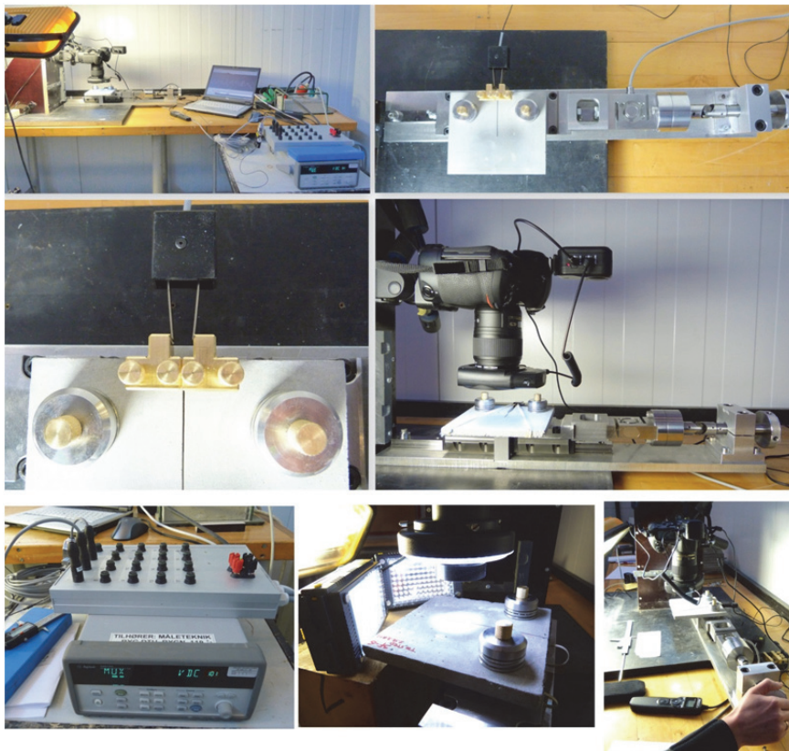
3.16. att. Plaisu rašanās un tālākas attīstības noteikšana uz jaunizveidotā, vienasīgā pārbaudes stenda stiprē ar bezkontakta digitālo attēlu pārvietojumu noteikšanas un analīzes sistēmu GOM „Aramis” (DTU laboratorija)
