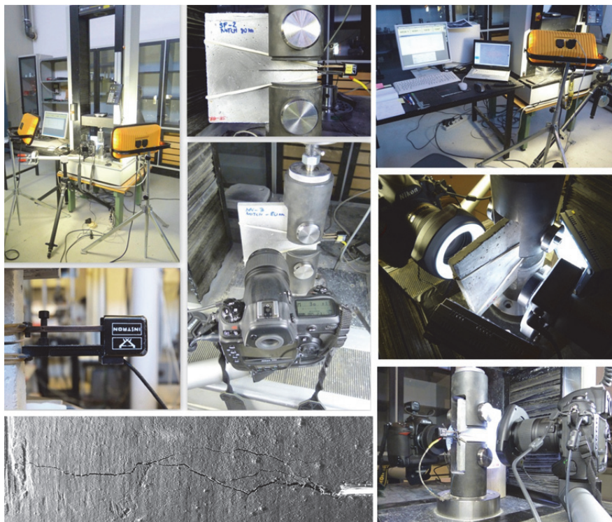
3.3. att. Plaisu rašanās un tālākas attīstības noteikšana, izmantojot arī bezkontakta digitālo attēlu pārvietošanu noteikšanas un analīzes metodiku (DTU laboratorija)
