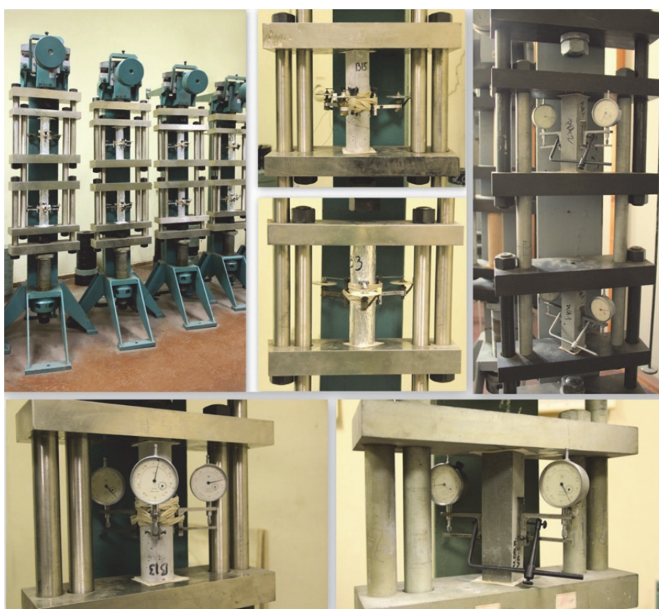
3.1. att. Šļūdes vienasīgo deformāciju spiedē noteikšana (RTU laboratorija)
