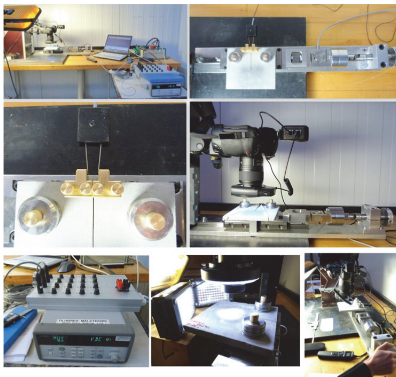
3.4. att. Plaisu attīstības izpēte uz jaunizveidotā pārbaudes stenda stiepē, izmantojot arī bezkontakta digitālo attēlu pārvietojumu noteikšanas un analīzes metodiku (DTU laboratorija)
