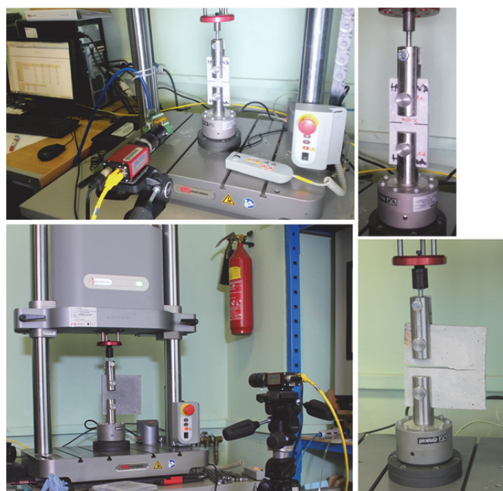
3.5. att. Stiepes stiprības, stiepes slodzes un plaisu atvēruma lieluma noteikšana ar kuponveida un koncentrētas stiepes paraugiem, izmantojot bezkontakta digitālo pārvietojumu noteikšanas metodi „Imetrum” (RTU laboratorija)
