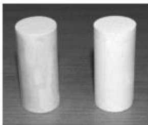
3.46. attēls. Sintezētās saistvielas paraugi mehānisko īpašību noteikšanai [93].
