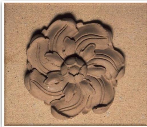
1.1. attēls. Romāncementa ornamenti, izgatavoti no eksperimentāli sintezēta kaļķakmens romāncementa ROCEM projekta ietvaros (2003–2006).
