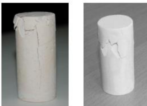
3.48. attēls. Divi dominējošie paraugu deformācijas (sabrūkšanas) tipi.
