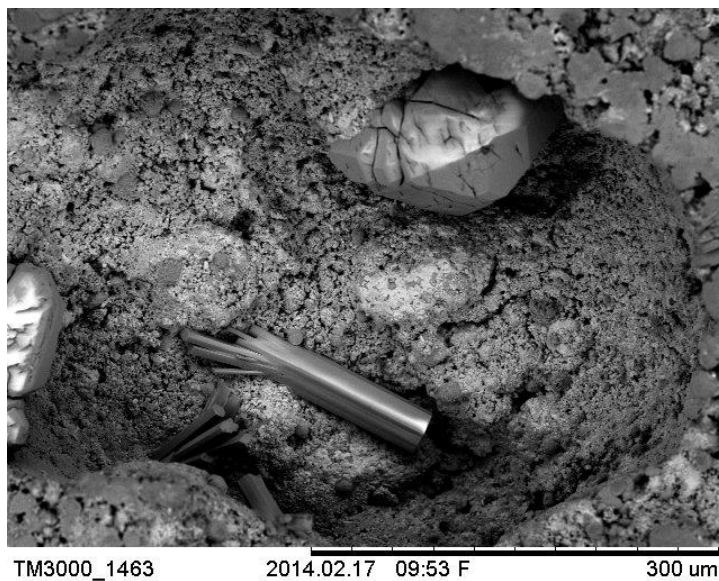
5. attēls. Jaunu kristālu veidošanās porā (sastāvs A1, cietējis 5 ned., 300x paliel.).
