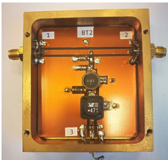
3.14. att. Filtra prototips ar korpusu (BT2), spiestās plates GND slānis novietots kontaktā ar korpusu un SMA savienotāju ārējais slānis pievienots spiestās plates GND slānim.
