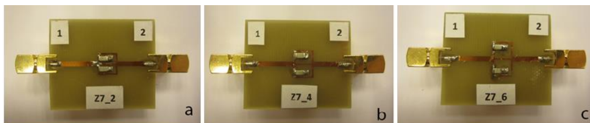
2.92. att. Spiestās plates z7, kur kondensatori atrodas attālumā d viens no otra. a – d = 2 mm, b – d = 4 mm, c – d = 6 mm.
