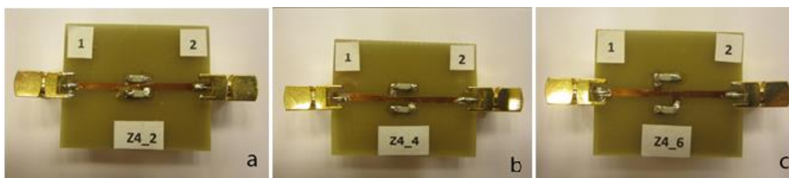
2.89. att. Spiestās plates z4, kur kondensatori atrodas attālumā d viens no otra. a – d = 2 mm, b – d = 4 mm, c – d = 6 mm.
