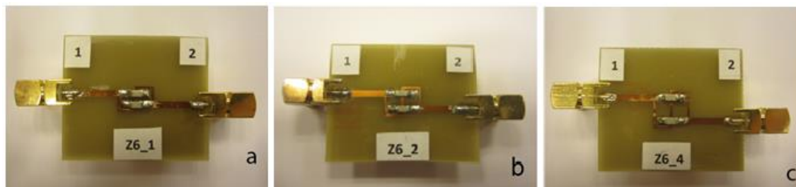
2.91. att. Spiestās plates z6, kur kondensatori atrodas attālumā d viens no otra. a – d = 1 mm, b – d = 2 mm, c – d = 4 mm.
