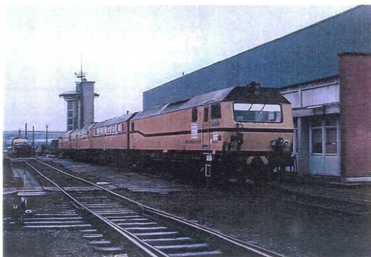
рис.2 Рабочий поезд для шлифования рельсов "SPENO RR40 MF2"
