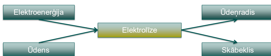
1.19. att. Ūdeņraža iegūšanas ar elektroenerģiju princips
