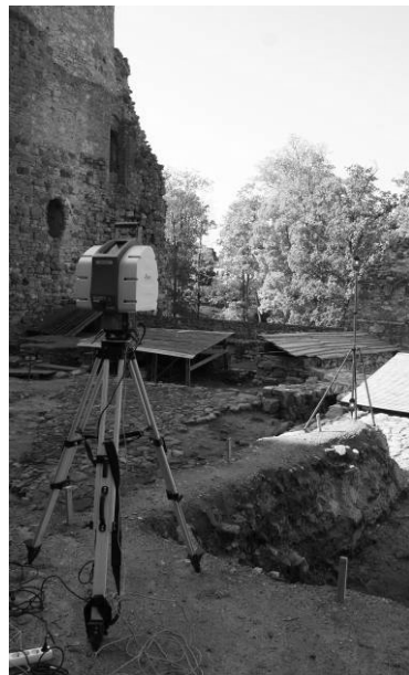
2.att. Leica HDS 3000 lāzerskeneris darba procesā pils pagalmā
