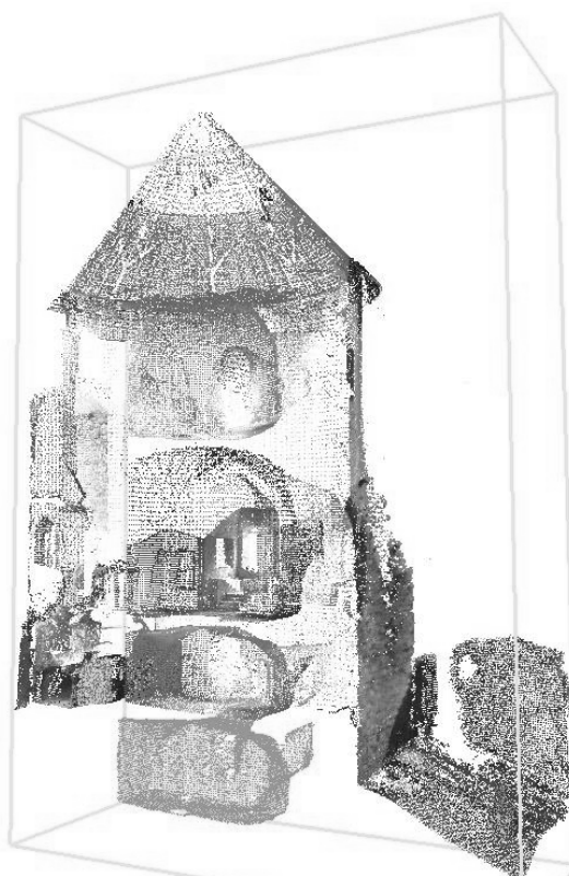
6.att. Rietumu tornis punktu mākoņa veidā un tā vertikālais griezums[6]
