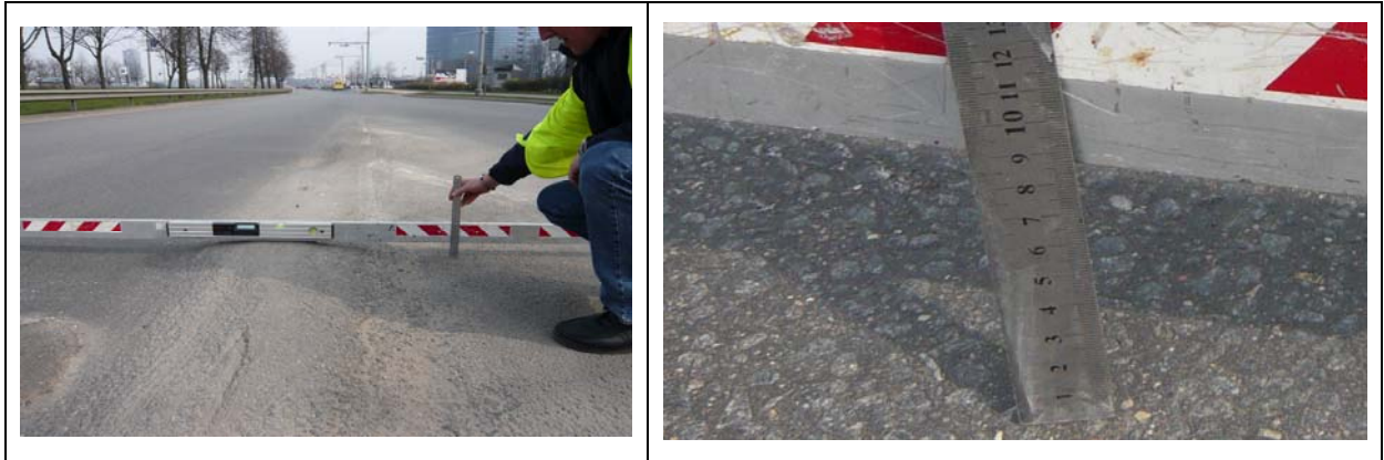
1.3. att. Ceļa segas līdzenuma mērījumi ar 3 m garu mērlatu un lineālu
