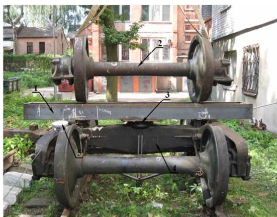
2.1. att. Eksperimentālā iekārta ratiņu griešanās pretestības momenta noteikšanai atbalsta mezglā:
