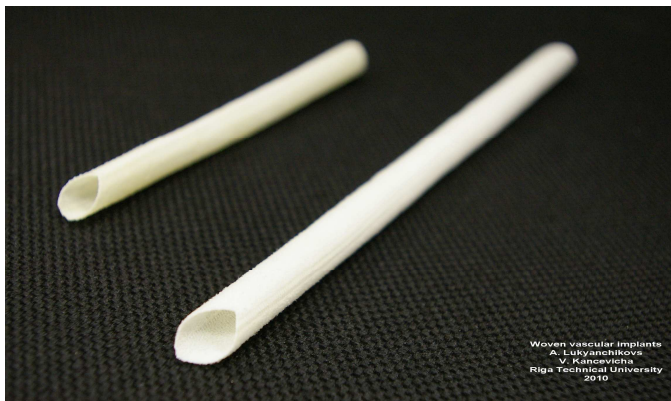
1. att. Dažāda diametra austi aortas implanta stobri ar inovatīvu sienas struktūru
