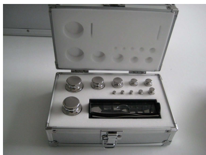
3. att. Tipiskais F 1 precizitātes klases atsvaru komplekts
