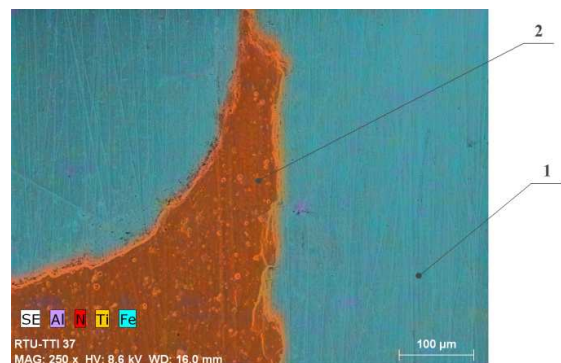
10.att. Parauga ar nodilumizturīgu pārklājumu nodiluma izmēģinājumu rezultāti: 1 – pamatmateriāls; 2 - pārklājums
